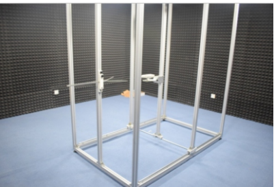
玩具消音室, 玩具的静音测试
