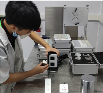
量规结构检查
